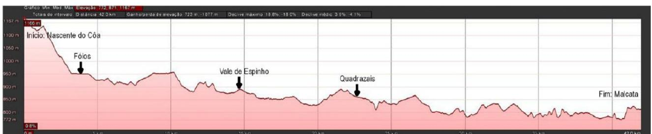
O percurso é predominantemente a descer, a prova de 42km tem **1077m de desnível negativo (D-)** e **723m de desnível positivo (D+)**. O que segundo a classificação ATRP dá um **Rácio de 1,72** (D+acum/Distância em metros) x 100, sendo assim, a **dificuldade é de grau 1**.
